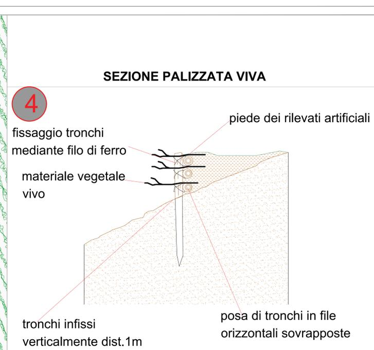
Al piede dei rilevati artificiali realizzati con materiale di riporto per evitare eventi erosivi superficiali causati dal dilavamento delle acque saranno realizzate delle palificate vive.
